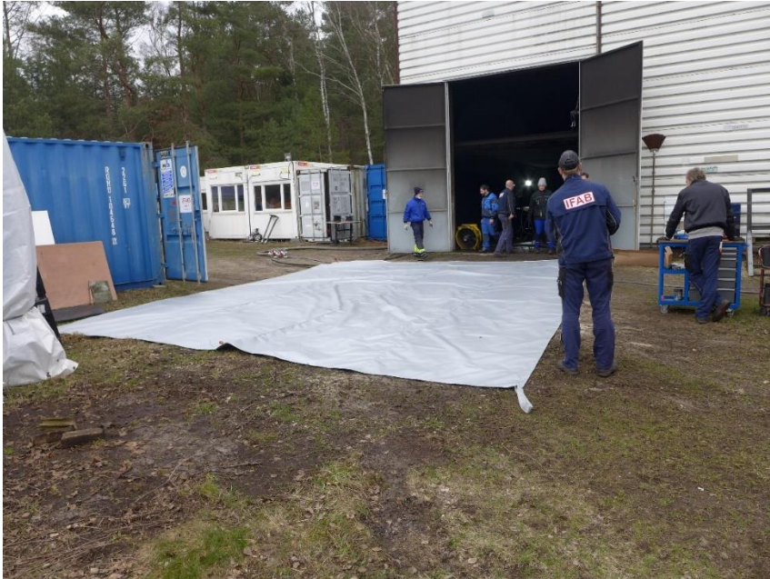
Bild 4: Typ A- Brandbegrenzungsdecke, vor dem Zerschneiden
