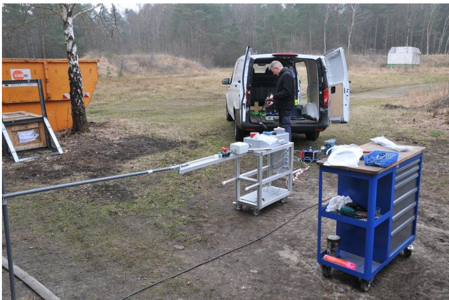
Bild 10: Absaugung für die Wasserstoffmessung, Messaufbau
