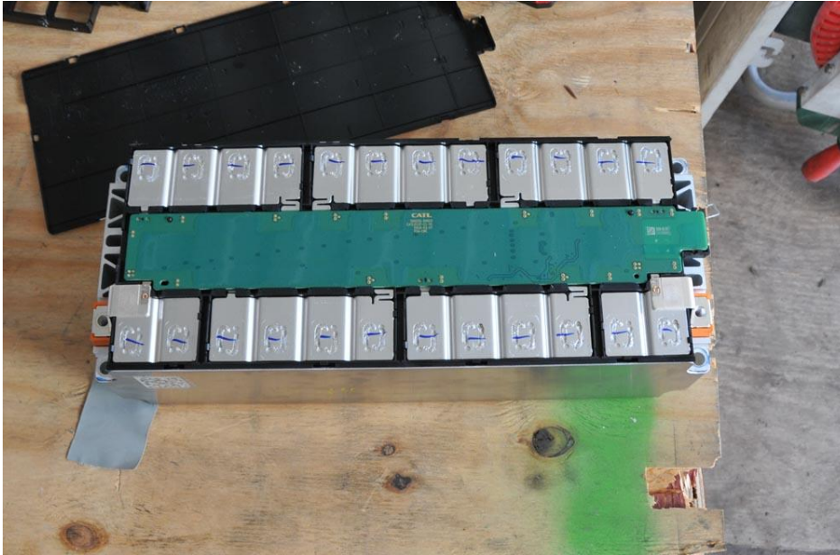
Bild 2: verwendetes Batteriemodul, bestehend aus 12 prismatischen Li-Ionen-Zellen
