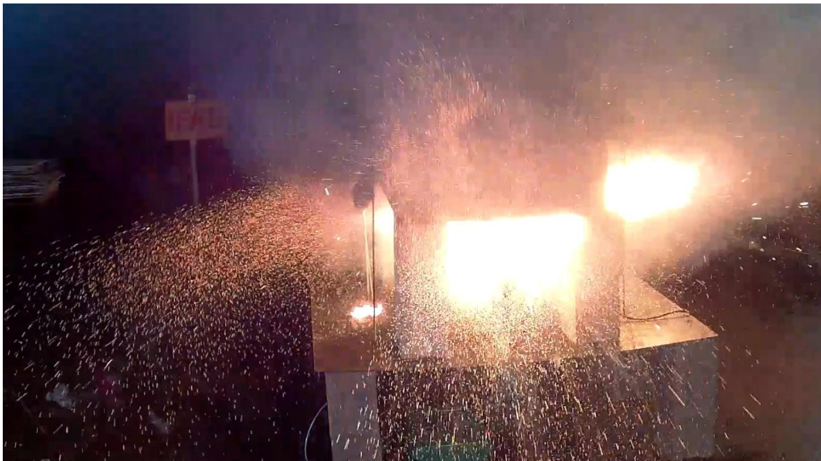
Bild 14: Wegsprühen von Teilchen während der Zellexplosionen
