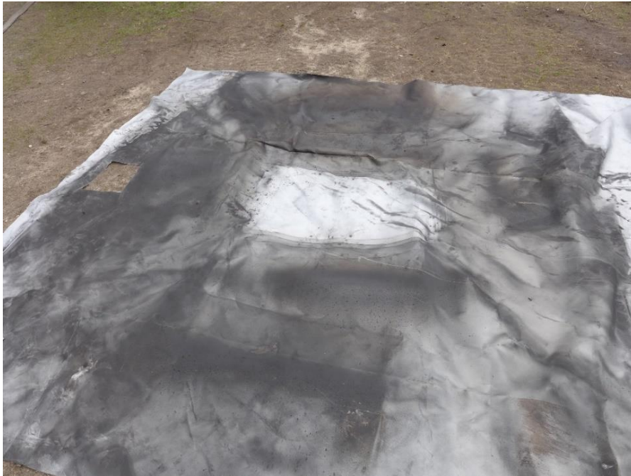
Bild 33: Brandbegrenzungsdecke nach Versuch – Probe herausgeschnitten
