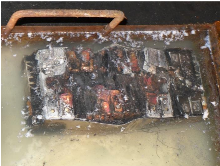
Bild 18: Rest Batteriemodul nach Versuch 2
