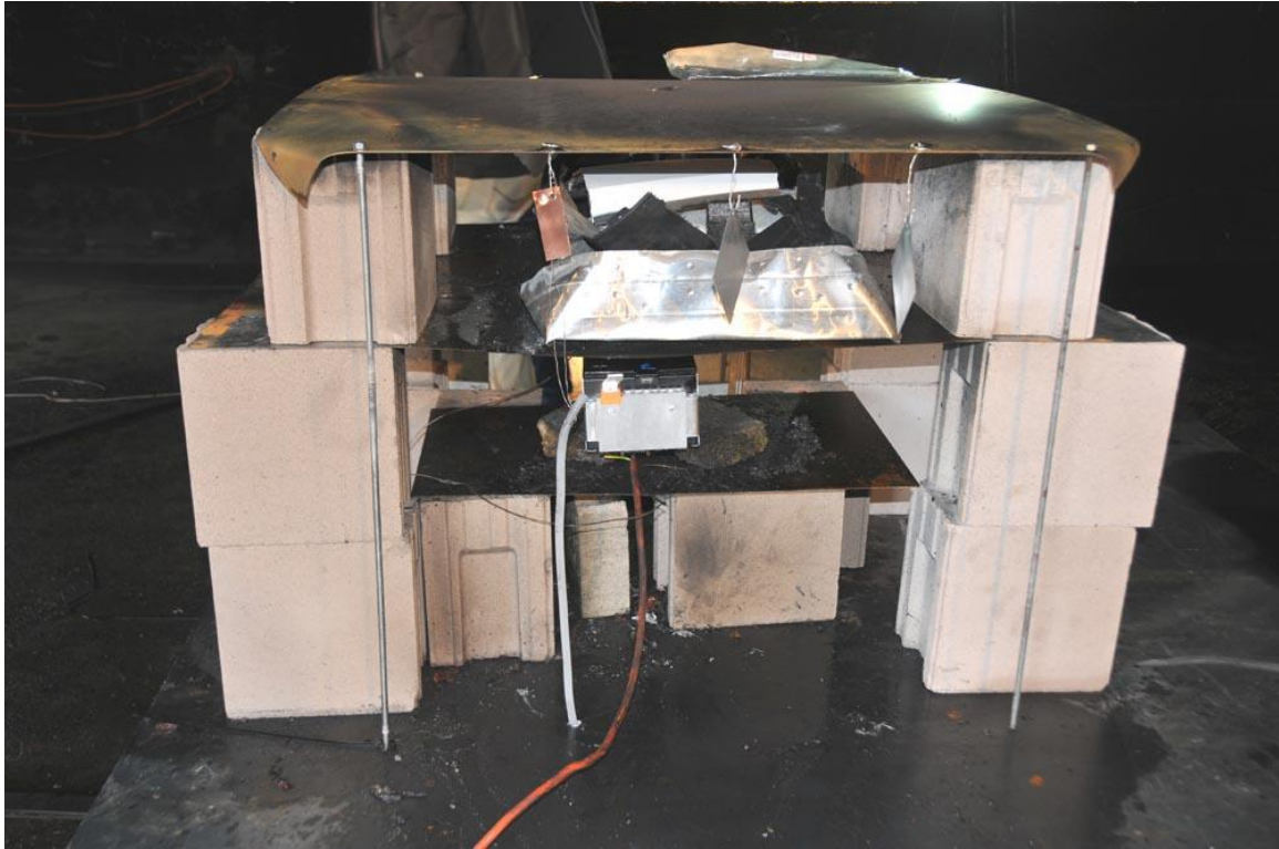
Bild 9: Versuchsaufbau Vorderansicht, Metallproben an oberer Stahlplatte angehängt, weißer Schlauch mittig: Ansaugstelle für Wasserstoffmessung
