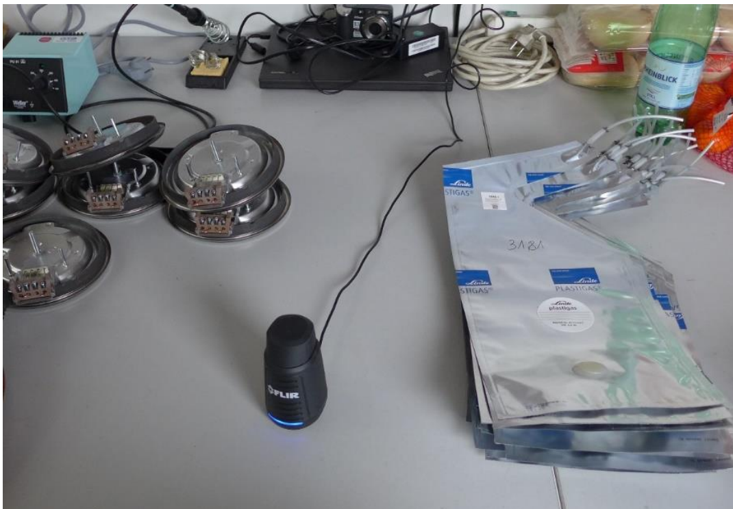
Bild 6: Rechts- verwendete Gasprobenbeutel mit Sauganschluss, nach Befüllen kann der Beutel durch Umknicken des oberen „Zipfels“ dicht verschlossen werden, links- verwendete Heizplatten
