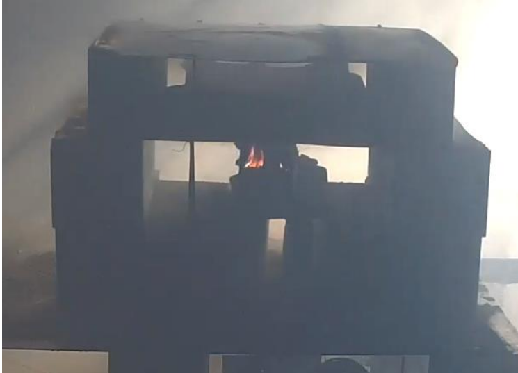
Bild 26: kleine Flammen im Batteriemodul nach Abnehmen der Decke
