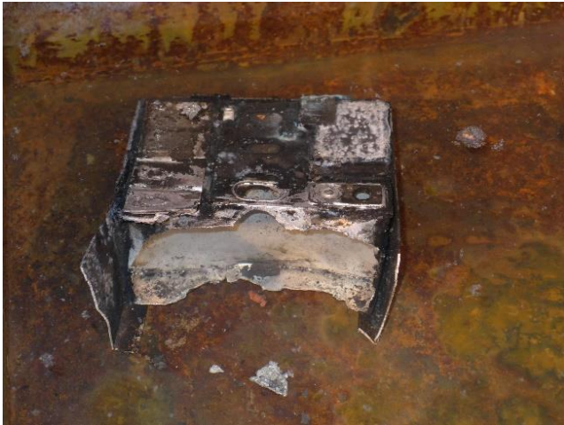
Bild 15: Versuch 1 – zerfallenes Batteriemodul
