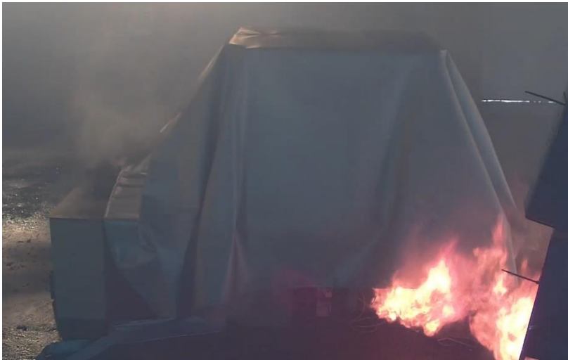
Bild 21: Durchzündung unter der Decke, Wegschleudern der Halteschienen
