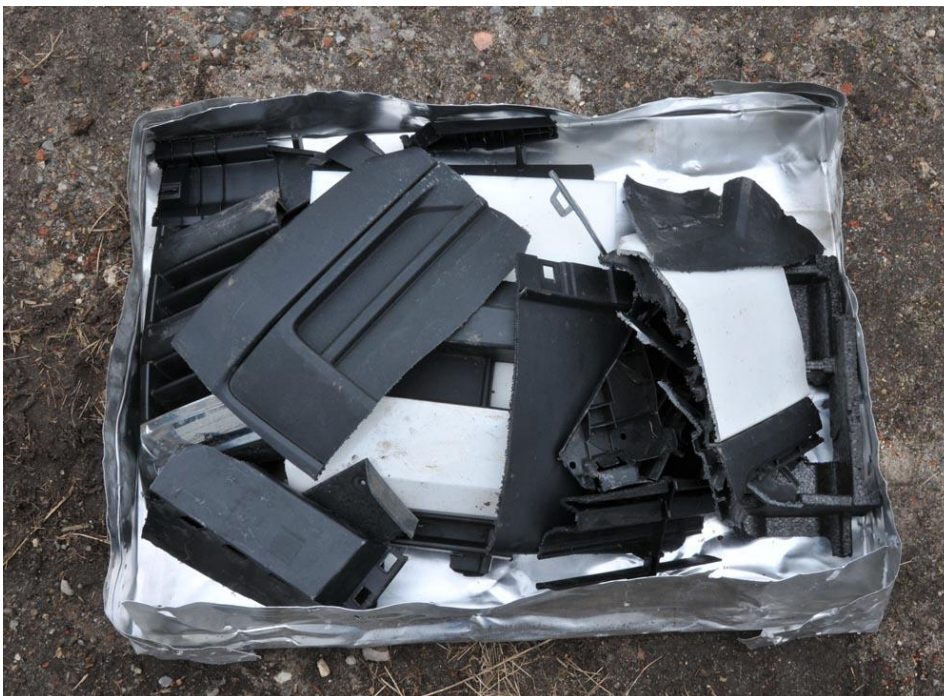
Bild 3: Aluminiumwanne mit Kunststoff-Materialmix
