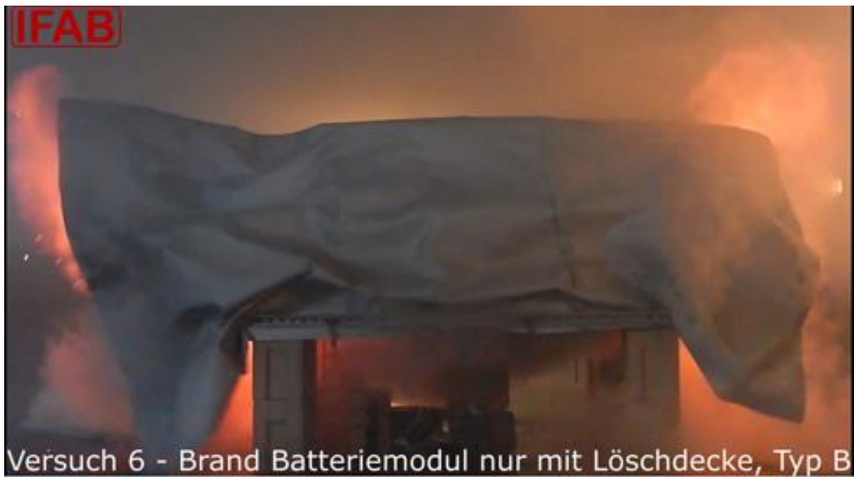
Bild 32: Durchzünden entweichender Gase, dabei Auffliegen der Decke
