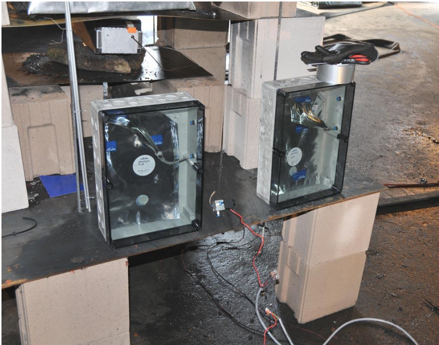
Bild 7: Gasprobenbeutel im Kunststoffgehäuse, Bildmitte: Mini-Membranpumpe
