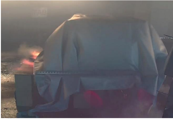
Bild 21: Durchzündung unter der Decke, Wegschleudern der Halteschienen
