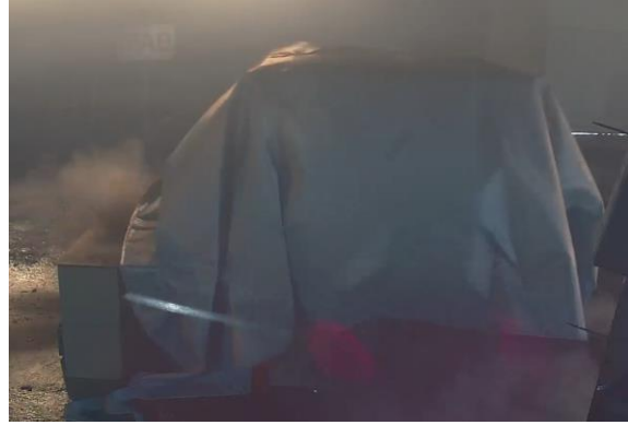
Bild 21: Durchzündung unter der Decke, Wegschleudern der Halteschienen
