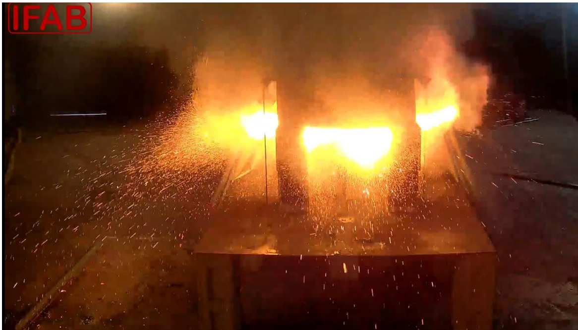
Bild 29: Durchzünden von Zellen, Wegfliegen von Teilchen, vor Auflegen der Brandbegrenzungsdecke
