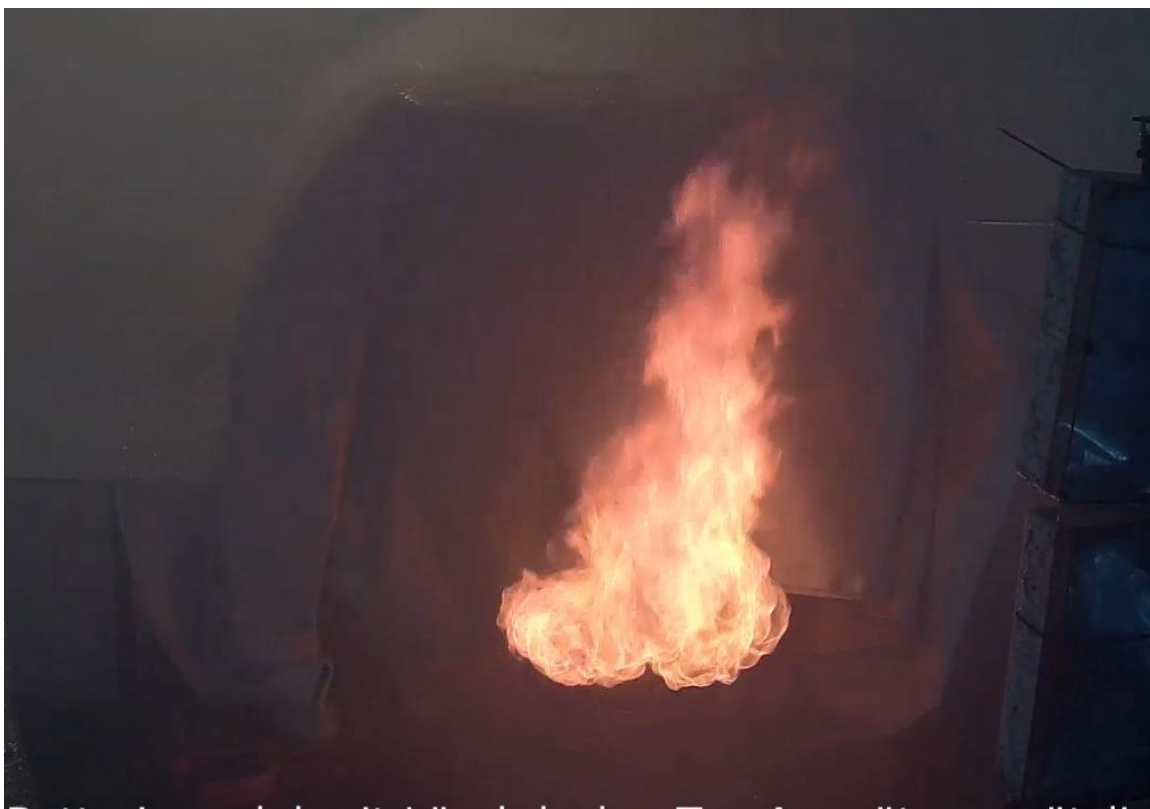
Bild 30: Entweichen von Gasen mit Durchzündung
