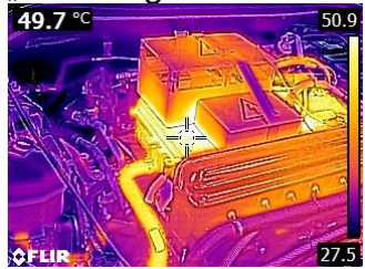
Steuerelektronik im Motorraum, mit Wasserkühlung
