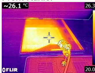
„Messung“ der Unterbodentemperatur via Spiegelung
