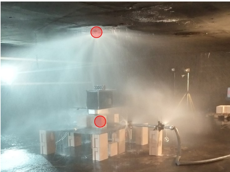
Abbildung 9: Versuchsaufbau „BDC von Unten + Sprinkler“
