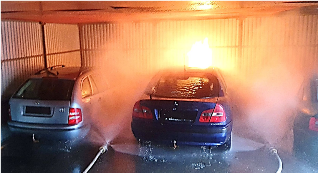
Abbildung 5 Boundary Cooling Device in Betrieb (Handling Tests)
