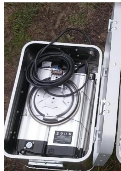
Bild 3: Aufbau: 4 Akkus in einer Box, Herdplatte als Zündquelle
