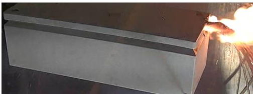
Bild 2: Präparierter Fahrradakku im Moment der Zündung während Thermal Runaway
