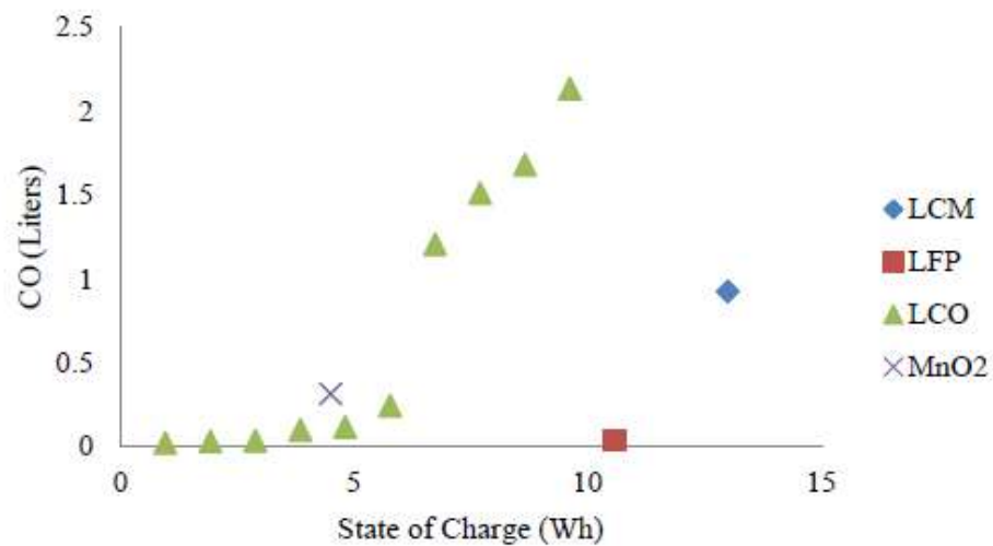
Abbildung 6: freigesetzte Gas für verschiedene Zellchemien [4] Dabei bedeutet LCM Li-NiCoMn, LFP LiFePO 4 , LCO LiCoO 2 und MnO 2 LiMnO 2 . Es zeigen sich Übereinstimmungen mit den oben dargestellten Messungen aus [2], u.a. dass für LFP-Zellchemie kaum CO freigesetzt wird.
